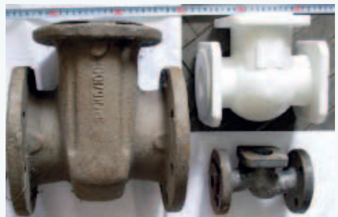
Модель и образцы отливок корпусов задвижек, выполненных по технологии ЛГМ
