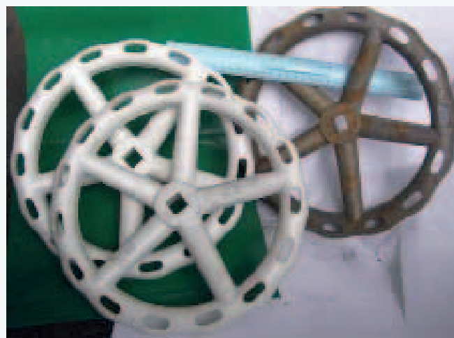
Маховик задвижки, модель и отливка
